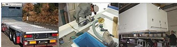
①車体(シャーシ) ②水槽(タンク)組立 ③水槽乗せ込み
